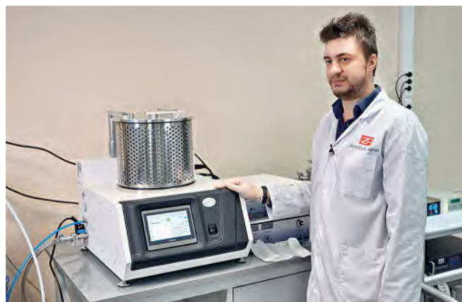
Рис.3. Установка нанесения тонких пленок методом термического испарения DTT
