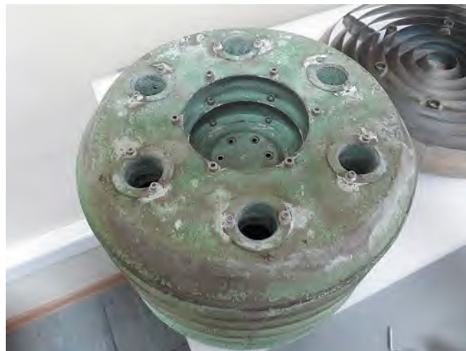
Рис.1. Вторая ступень криогенного насоса до восстановления Fig.1. The second stage of the criogenic pump before recovery
