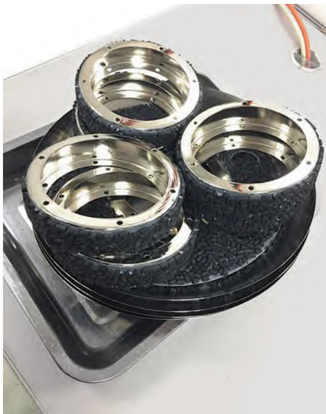
Рис.2. Части второй ступени криогенного насоса после восстановления
